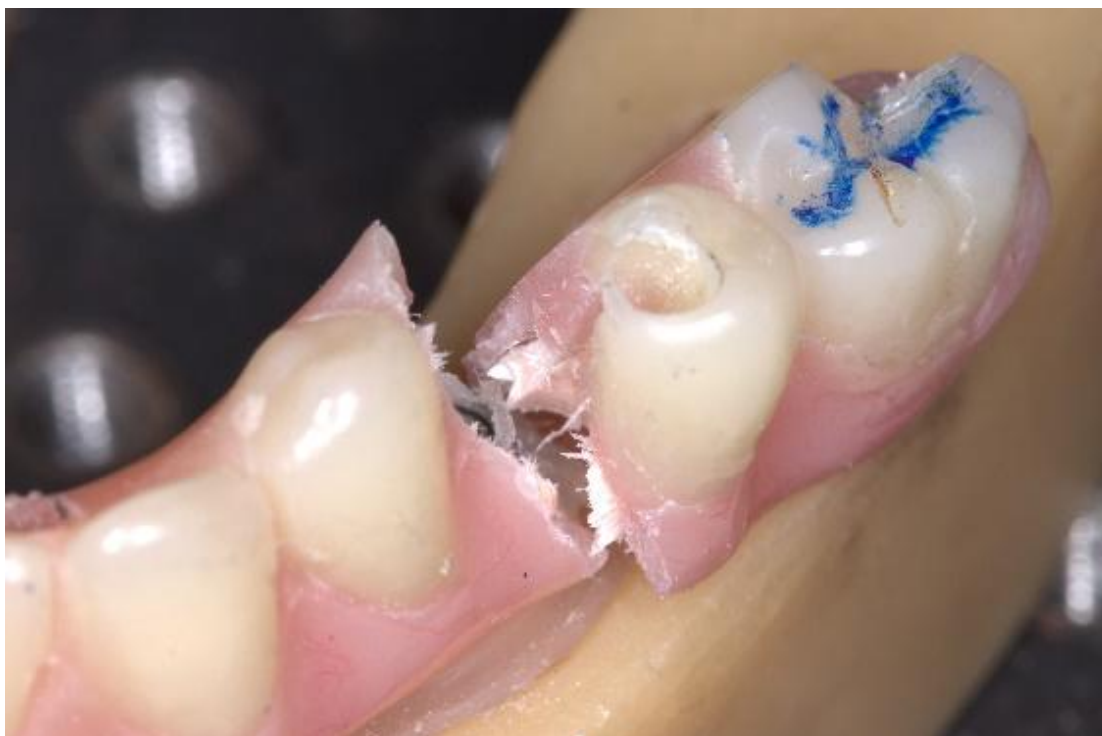
Figura 19: Proceso de prueba de esfuerzo realizada con maquina universal Instron, zona de voladizo izquierdo cuerpo de muestra 10 mm B.
