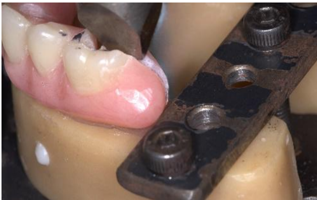
Figura 12: Proceso de prueba de esfuerzo realizada con maquina universal Instron, zona de voladizo izquierdo cuerpo de muestra 7 mm AB.
