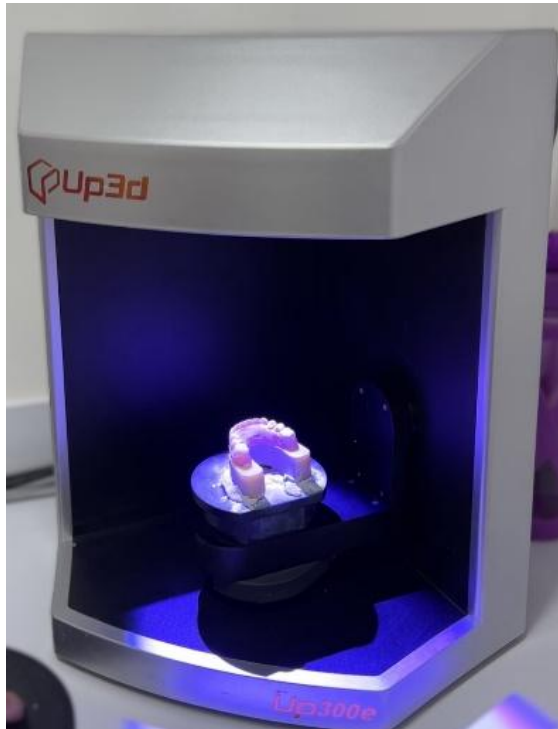
Figura 3: Escaneo de los enfilados maestros con escáner de mesa Up3d 300e.
