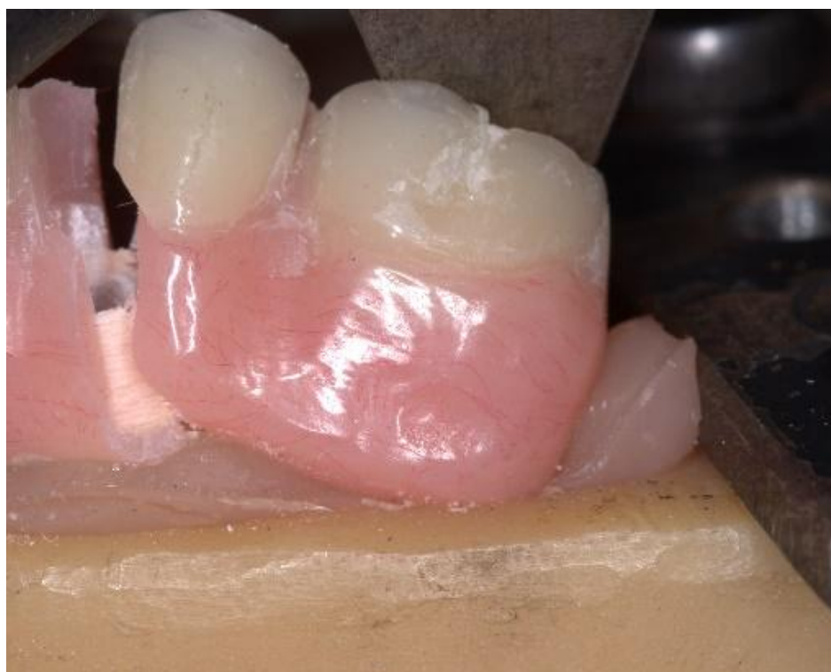
Figura 20: Proceso de prueba de esfuerzo realizada con maquina universal Instron, zona de voladizo izquierdo cuerpo de muestra 7 mm B.
