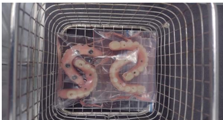
Figura 8: Cuerpos de muestra en inmersión de saliva artificial (Salivar NF®)
