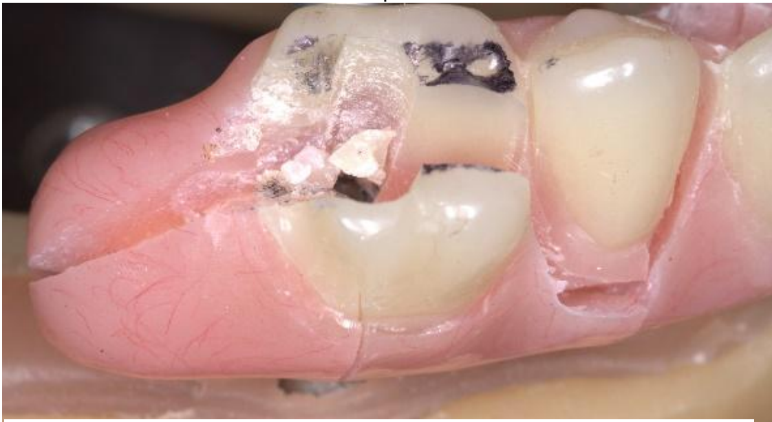
Figura 14: Proceso de prueba de esfuerzo realizada con maquina universal Instron, zona de voladizo izquierdo cuerpo de muestra 7 mm B.
