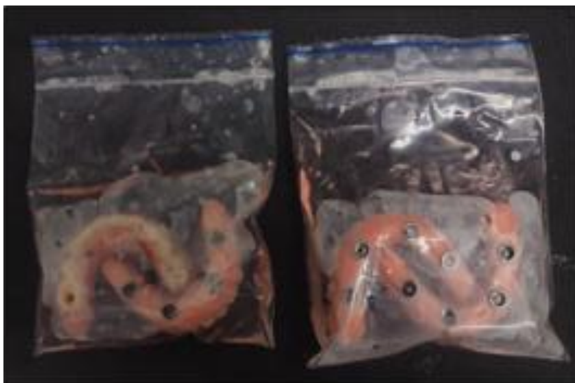
Figura 9: Cuerpos de muestra después del proceso de termociclado.
