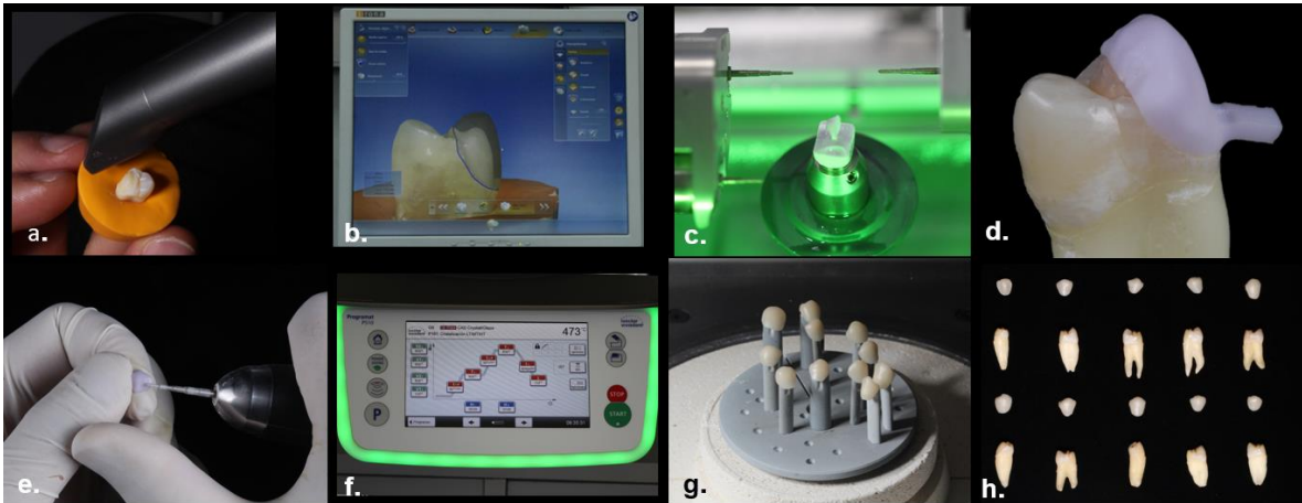
Ilustración 2 Secuencia de fabricación digital. a. Escaneo con escáner intra-oral (CEREC, Omnicam, Sirona) b. Diseño estandarizado. c. Fresado. d. Carilla pre-cristalizada. e. pulido. f. Secuencia de temperatura para cristalización. g. Carillas cristalizadas. h. Muestras listas para cementación.
