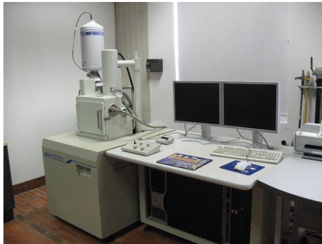
Figura 5. Microscopio Electrónico de Barrido JEOL JSM 6490
