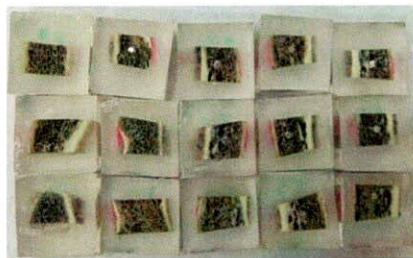
Figura 7. Recubrimiento de espécimen con resina epóxica.
