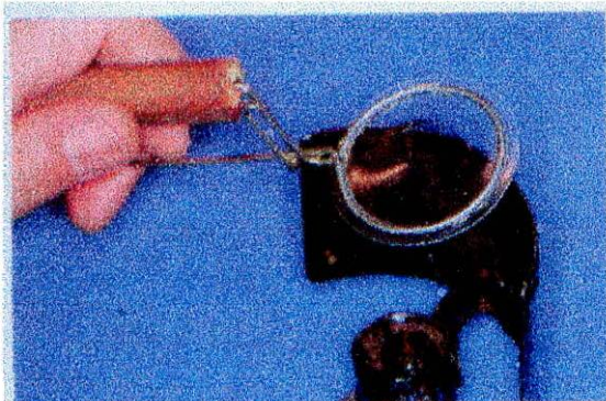
FIGURA 42. Calentamiento para reblandecer el plástico, se evita la llama directa y se espera a que se torne transparente.
