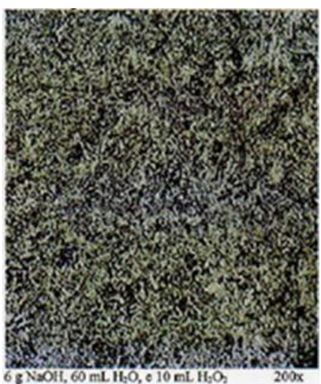
Metalografía minimplante titanio grado 5 ® (Ti6Al4V)c
