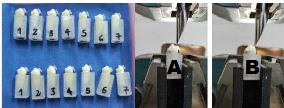
Ilustración 3 Cubos en acrílico donde se incorporaron los dientes; Adherencia a la cizalla en Brackets. Antes (a) y Después (b) del ensayo
