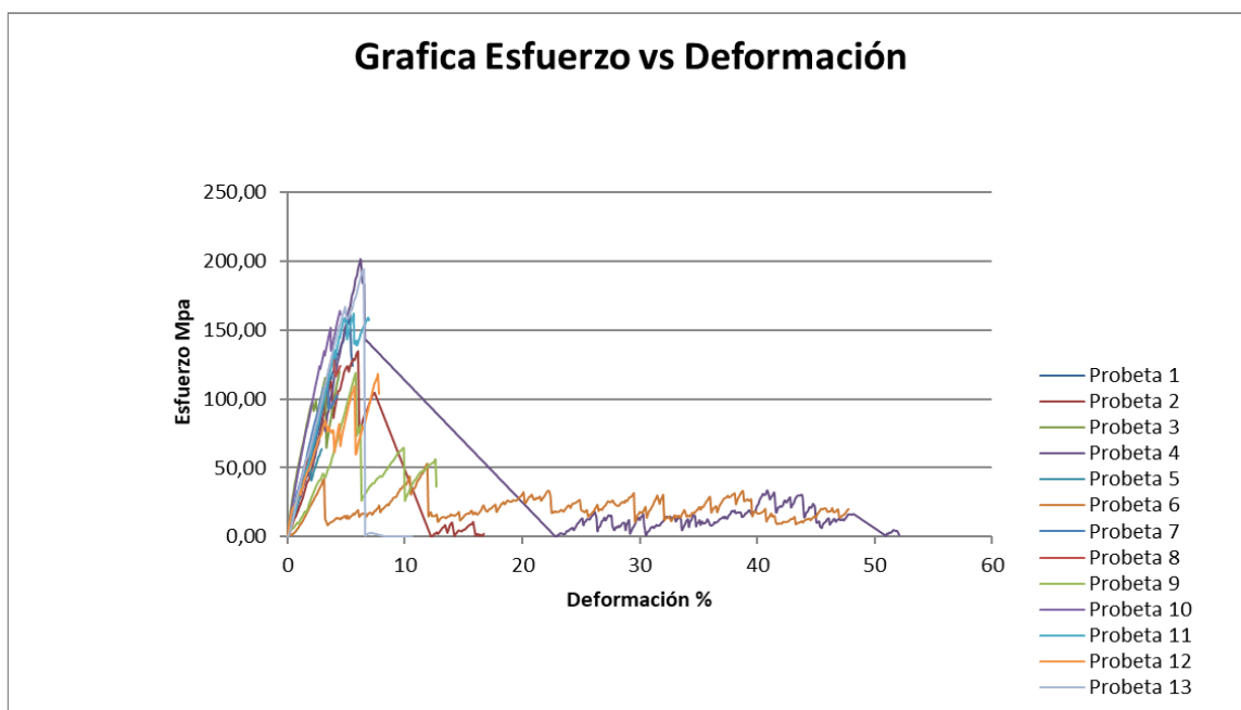
Gráfico 2. Gráfica de Resistencia a la compresión en cilindros de 4 mm x 10 mm de resinas dentales nanohíbridas de Zafira Light Curing Composite®.
