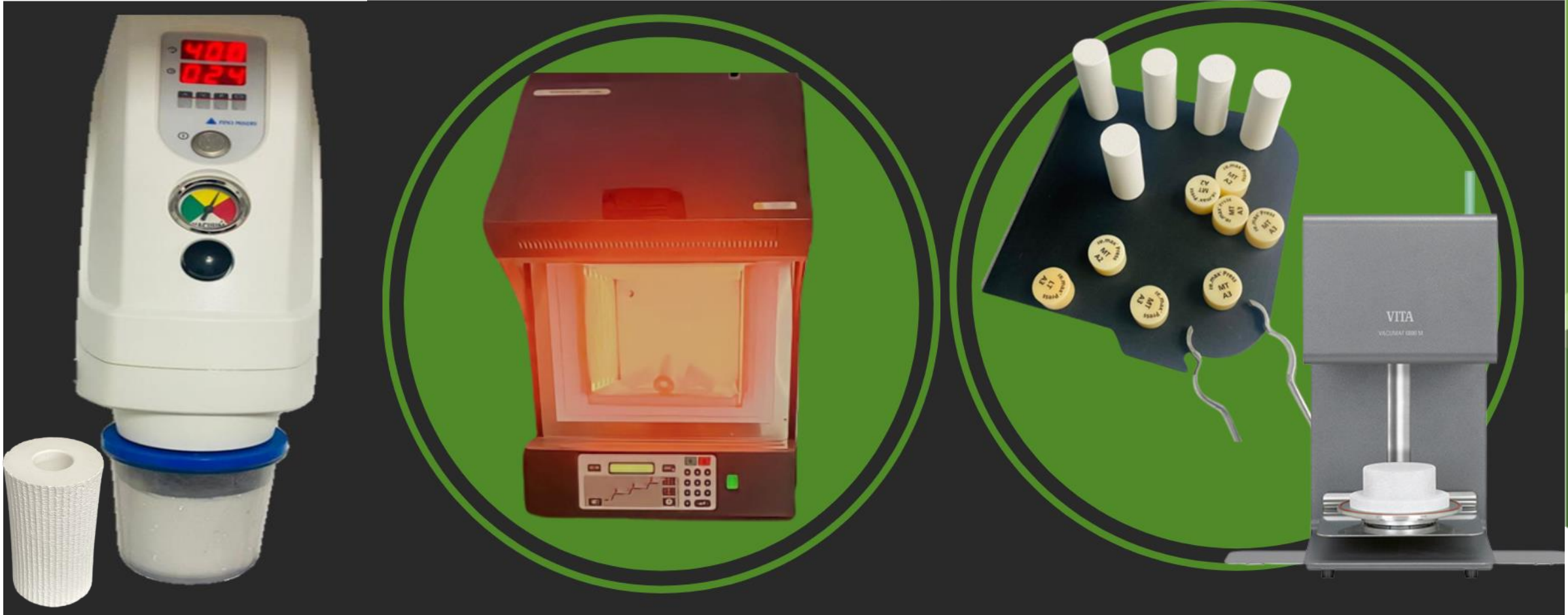
Fig.10 Inyección de la cerámica en el horno VITA (VACUMAT 6000 MP)
