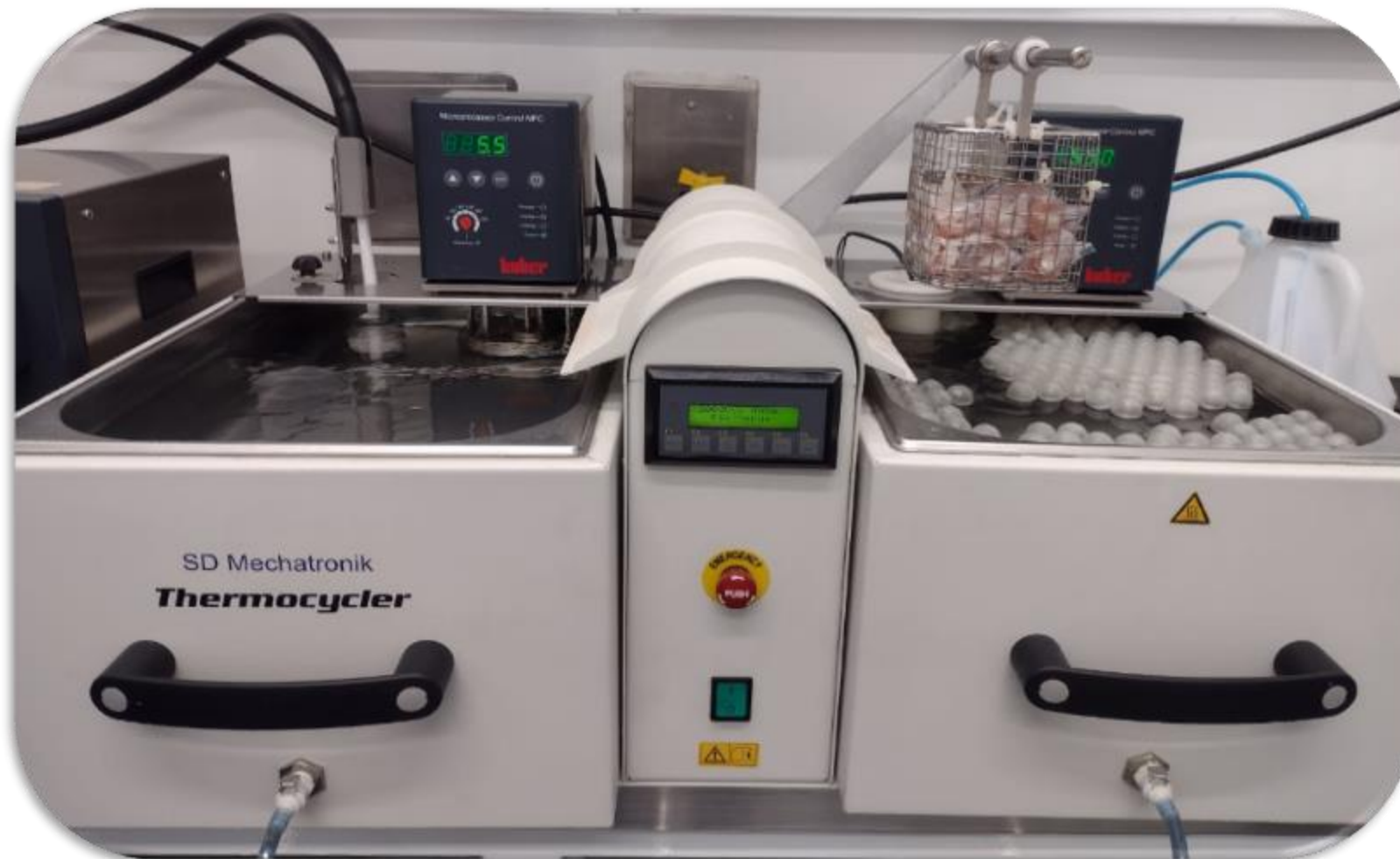
Fig.21 Proceso de termociclado con Thermocycler 1100/1200, SD-Mechatronik, Westerham, Alemania
