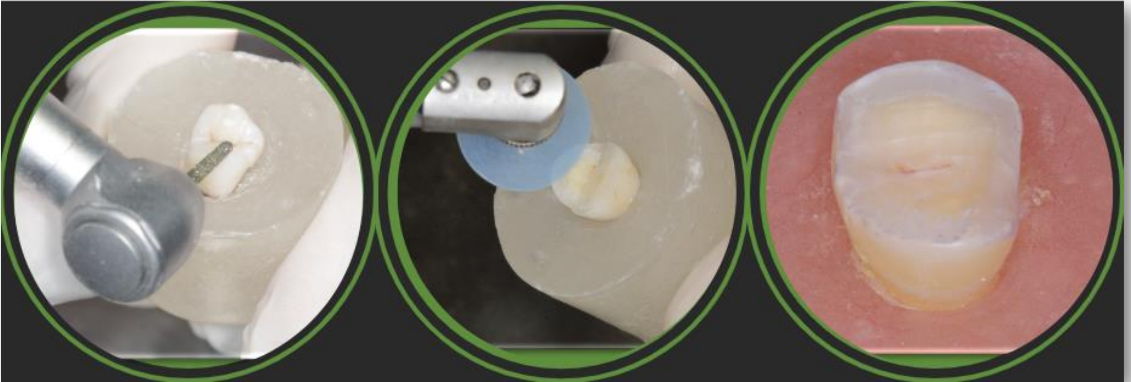
Fig.1 Los especímenes se insertaron en bloques de acrílico y se simuló desgaste dental severo con fresa troncocónica 4138 (KG Sorensen)
