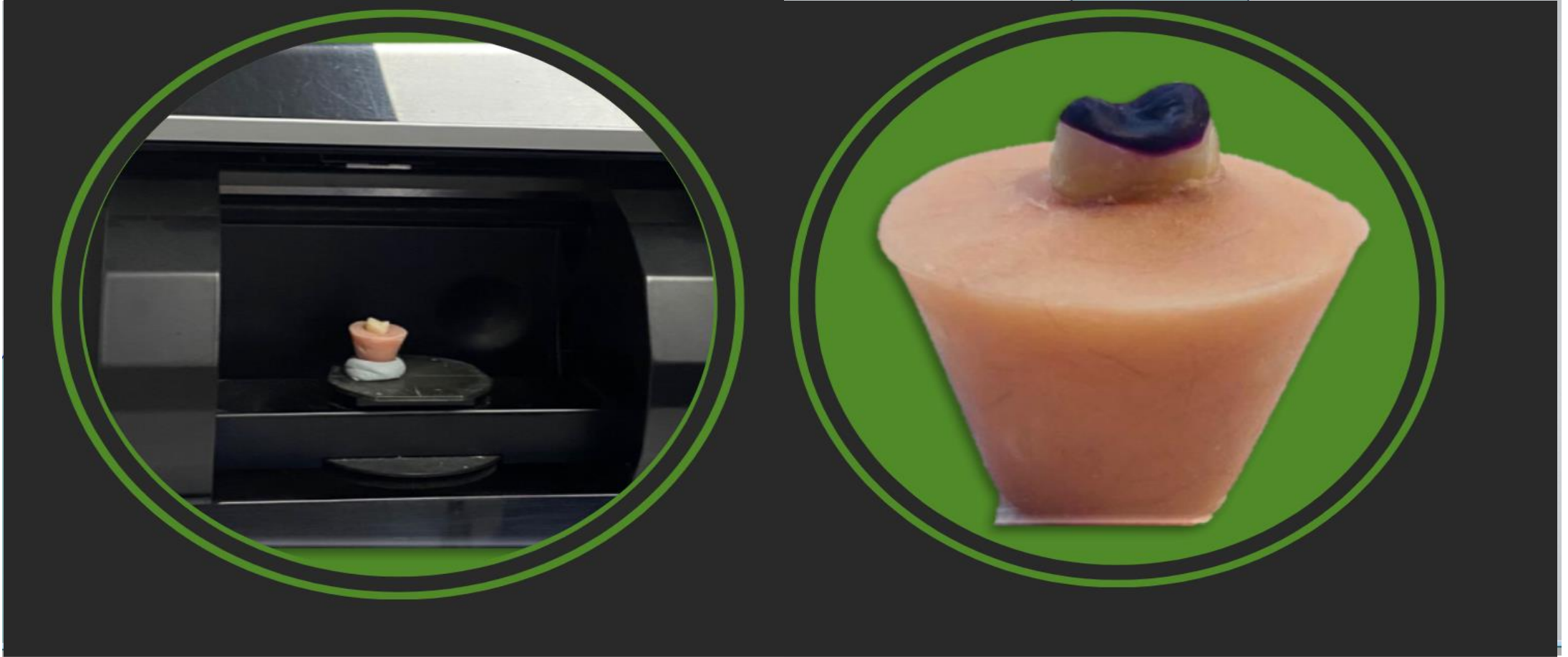
Fig.7 Impresión en 3D (Formlabs2) en material calcinable, se comprobó adaptación
