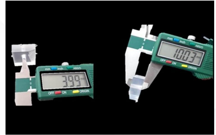
Calibración de moldes impresos para cuerpos de muestra utilizando pie de rey
