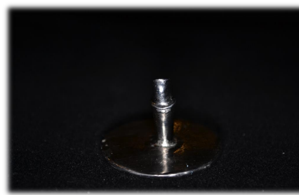
Figura 3. troquel definitivo colado
