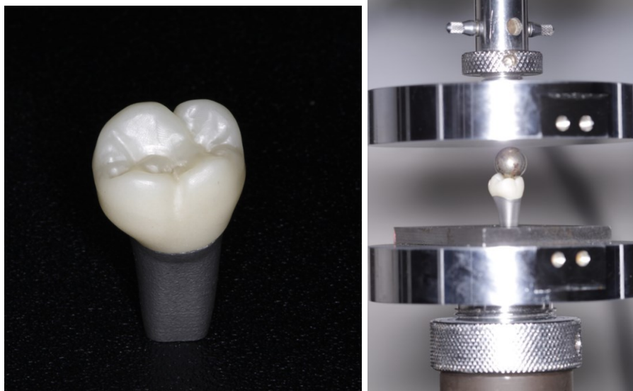
Ilustración 3. A. Corona monolítica de zirconia multicapa sobre su pilar metálico lista para la prueba de fuerza B. Esfera metálica sobre la corona recibiendo fuerza de la máquina de ensayo universal INSTRON.
