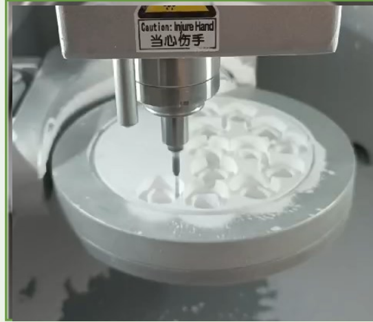
Fresado de coronas en cada uno de los discos fresadora Upcera A51 de 5 ejes
