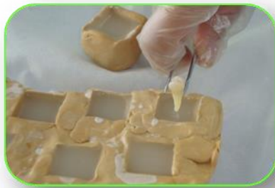
Figura 3. Colocación de premolar en cubo de acrílico
