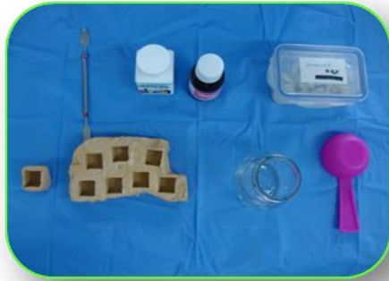
Figura 2. Moldes de cubo en silicona.
