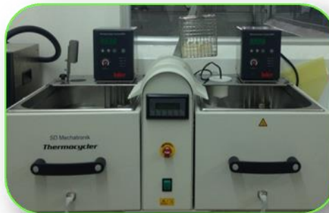
Figura 10. Pruebas de Ciclaje Térmico.
