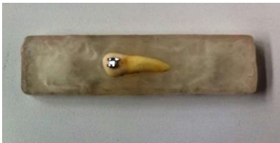
Figura 1 Bloque de acrílico usado con un premolar inmerso en la mitad, con bracket 3M™ cementado en el centro de la corona clínica
