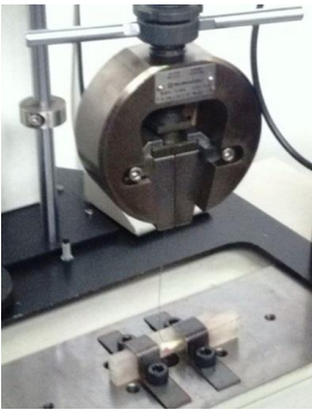
Figura 4. Dispositivo metálico tipo tenaza que sostiene el extremo libre de la ligadura metálica
