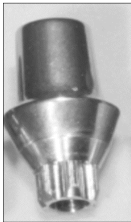
Grupo 2 6 Pilares diseñados con el sistema CAD/CAM en titanio maquinado Phibo®.
