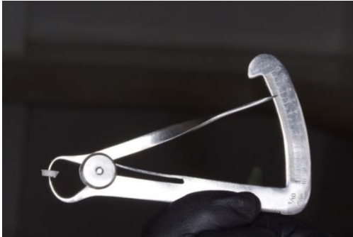
Imagen 6: Calibración del grosor posterior a la fotopolimerización.
