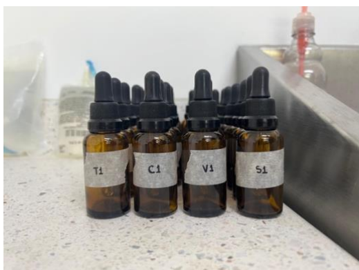
Imagen 14: almacenamiento de las muestras en frascos de vidrio ámbar
