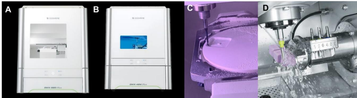
Figura 2. Proceso de fresado; A. Fresadora DWX - 52D ®; B. DWX-42 W®; C. Fresado discos de zirconio AT; D. Fresado bloques de disilicato de litio AT.
