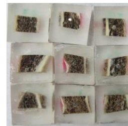
Figura 6. Recubrimiento de espécimen con resina epóxica.
