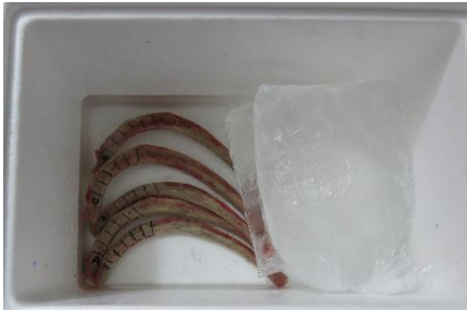
Figura 3. Refrigeración del espécimen en Formaldehído Buferado 10% a 4°C
