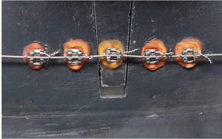
GRUPO 1 5 arcos seccionados de Gummetal 0.18x0.22
