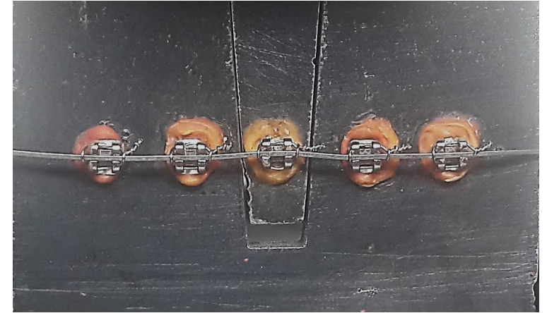
GRUPO 3 5 arcos seccionados de Nitinol 0.18x0.22
