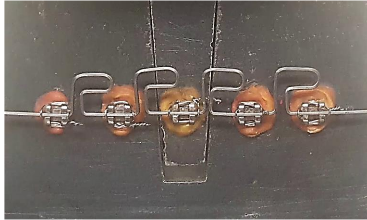
GRUPO 2 5 arcos seccionados Multiansas de Acero 0.18x0.22
