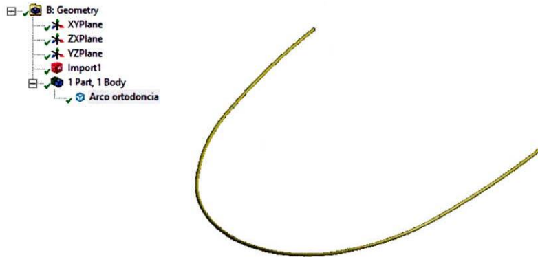
Fig. 19 Modelo CAD – arco de ortodoncia desing modeler ANSYS [autor]
