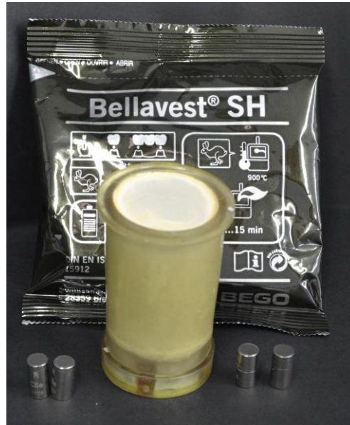
Figura 15. Revestimiento, anillo y metal utilizado
