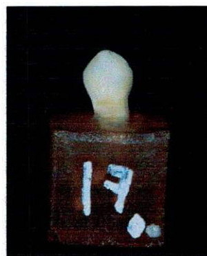
Figura 1: diente sumergido en los cubos de acrílico de 20mm por 20mm.
