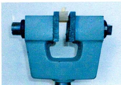
Figura 5: base metálica para soporte de cubos acrílicos de 20mm por 20mm.
