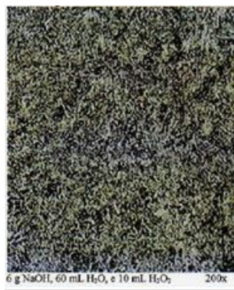
Figura2. Metalografía minimplante titanio grado 5 ® (Ti6Al4V)
