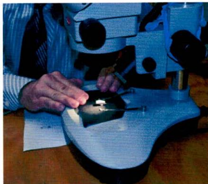
Figura 28. Medición de la adaptación marginal en estereomicroscopio.
