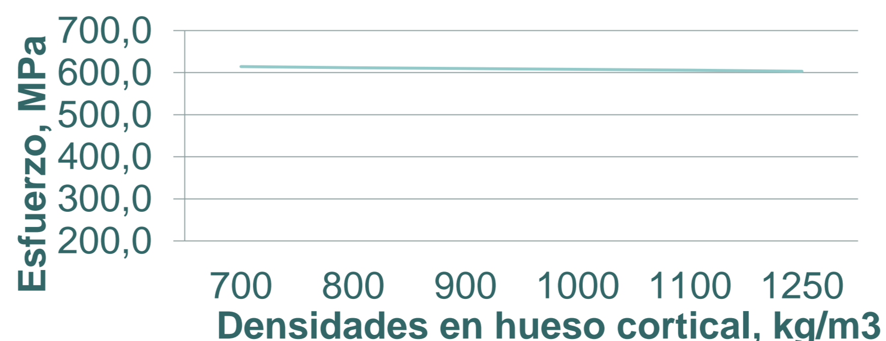
Figura 6. Esfuerzos producidos sobre mini-implante para diferentes densidades en hueso cortical.
