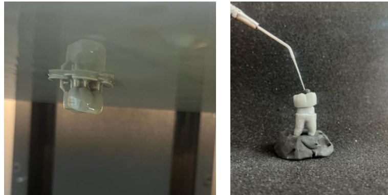
Imagen 18: impresión y verificación de adaptación de corona en prototipo
