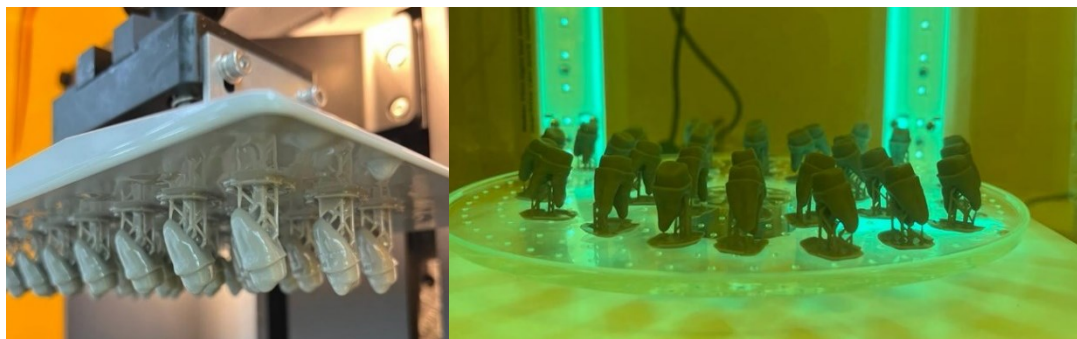
Imagen 16: Impresión y fotocurado N=48
