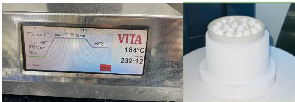
Imagen 21: Sinterizado de Zirconio a 1530°
