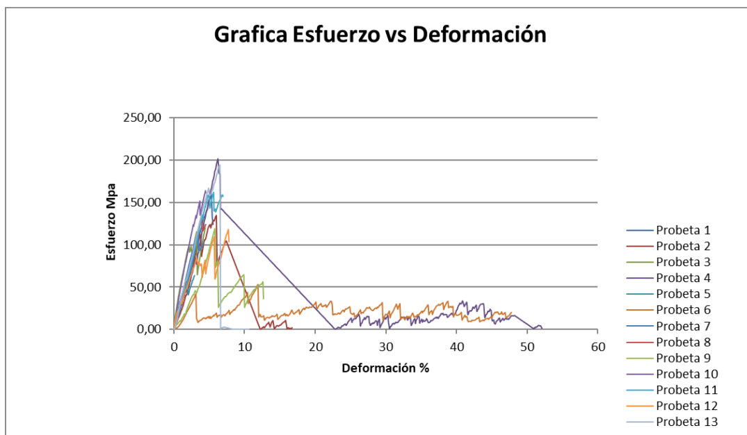
Gráfico 10. Gráfica de Resistencia a la compresión en cilindros de 4 mm x 10 mm de resinas dentales nanohíbridas de 3M™ Filtek™ Z250 XT®
