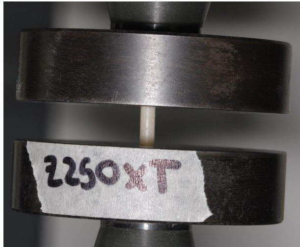
Gráfico 6. Ensayo de Resistencia a la Compresión de una Muestra en Máquina Universal Tinius Olsen.
