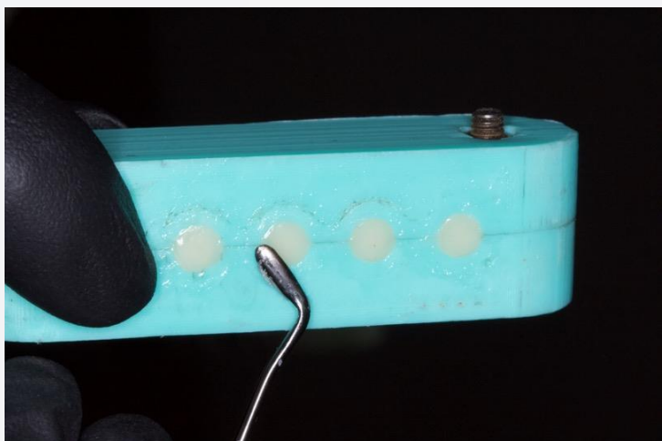
Imagen 1. compactación de la resina
