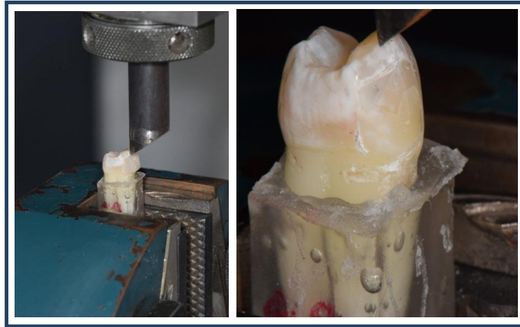
Fig. 11. Maquina universal Tinius olcen se realizó a una velocidad de ensayo de 1 mm/min con una carga de 10 KN
