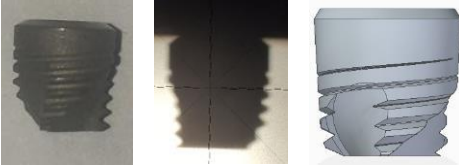
Figura 1. Metrología tornillo de fijación. a. Tornillo de fijación b. Imagen del tornillo de fijación en el proyector de perfiles. c. CAD del tornillo de fijación
