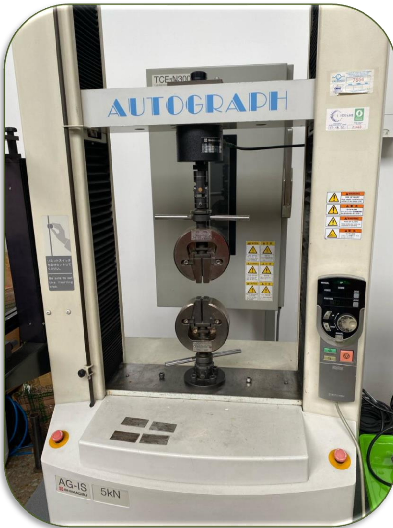
Maquina universal de ensayos mecánicos marca Shimadzu, modelo: AG-IS 5KN
