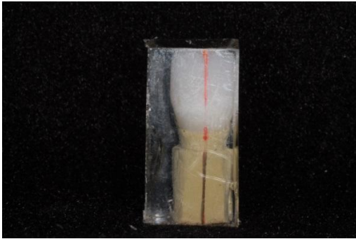
FIGURA 3. Inclusión de las muestras en moldes de resina epóxica
