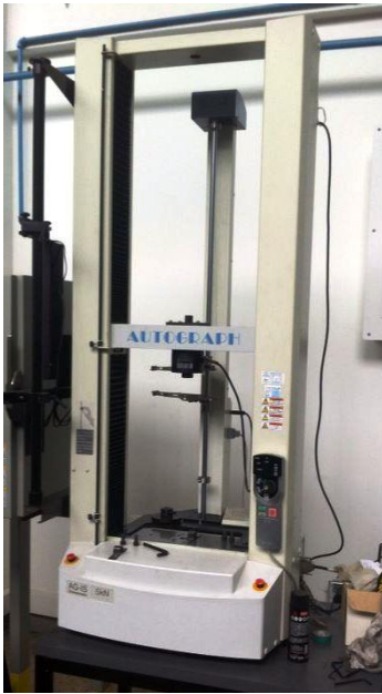
Figura 5. Aparato de medición Shimadzu Universal Testing Instruments serie AG-IS
