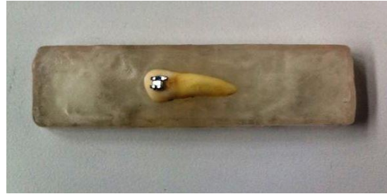
Figura 1 Bloque de acrílico usado con un premolar inmerso en la mitad, con bracket 3M™ cementado en el centro de la corona clínica
