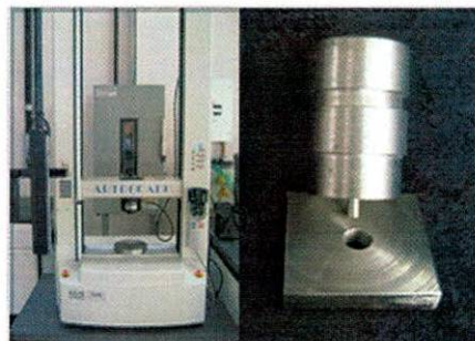
Fig. 3 Fotografía, Maquina universal de ensayos mecánicos, y Dispositivo utilizado en el test de microtensión
