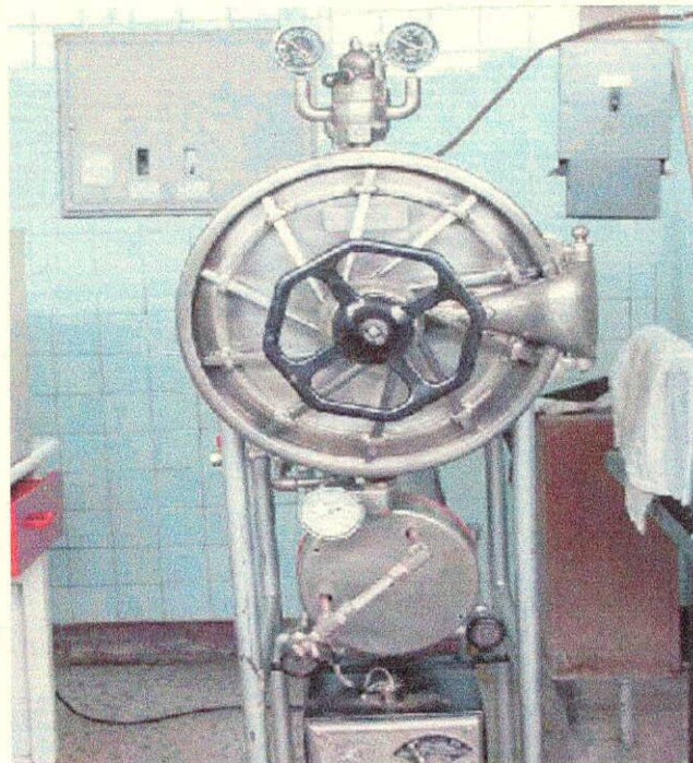
Figura 2. Horno (Esterilizador Calor Seco)
