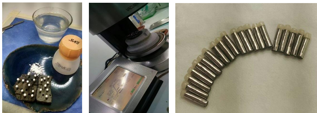
Figura 4. Adhesión de la cerámica en Co-Cr colado
