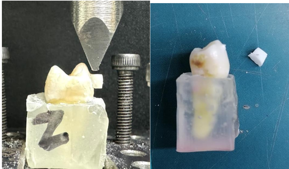
Gráfico 11. Proceso de cizallamiento de muestras
