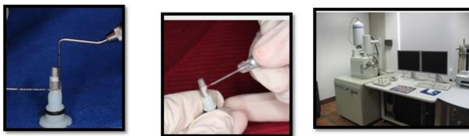
Fig. 1. Procedimiento y análisis en las superficies de los implantes. A. Delimitación de área de 3 mm donde se realizó irradiación con láser de diodo. B. Irradiación con láser de diodo. C. Microscopio electrónico de Barrido Joel modelo JSM-6490lv.
