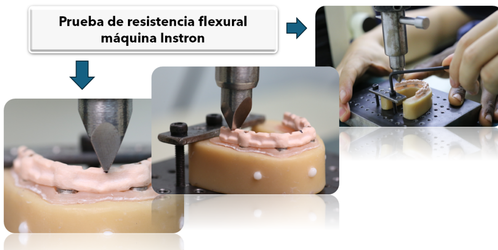
Figura 13. Pruebas de resistencia flexural maquina Instron
