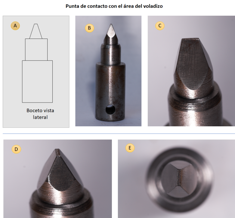
Figura 5. Diseño de la punta de contacto con el área del voladizo.
