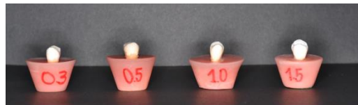
Figura 1. Distribución en grupos según espesor (0.3, 0.5, 1.0, 1.5 mm)
