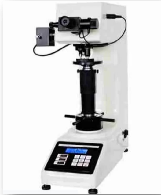
A. Durímetro Indenta Met, modelo 1104
