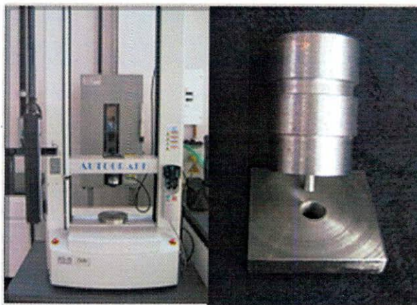
Fig. 3 Fotografía, Maquina universal de ensayos mecánico, y Dispositivo utilizado en el test de microtensión
