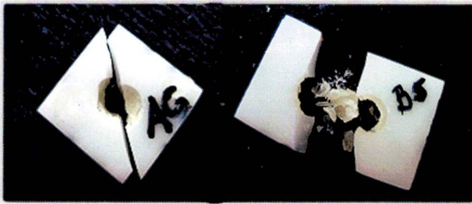
Fig. 6 Fotografía, falla de tipo cohesivo de la cerámica de revestimiento
