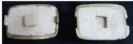
Figura 7. Proceso de enmuflado por medio del molde maestro obtenido anteriormente.
