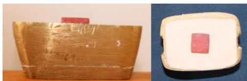
Figura 6. Proceso de elaboración de molde maestro para verter acrílico de termocurado.
