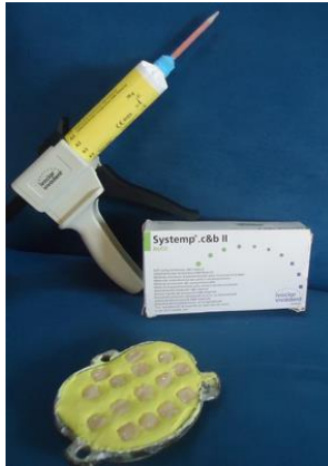
Figura 8. Bis-Acril con el molde maestro para la obtención de las muestras
