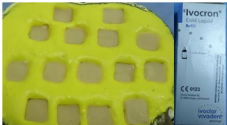
Figura 5. Molde en silicona donde se verterá el acrílico de autocurado.
