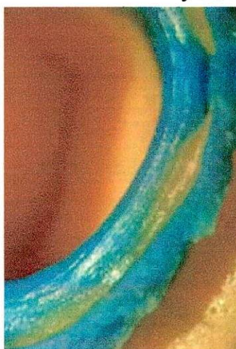
Particolare allo stereomicroscopio (16x) di impronta monofase con Medium e Low Viscosity.
