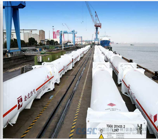
Imagen 8: Contenedor cisterna de GNL de 40 pies /45 pies T75, tomado de CSSC Chengxi (Taizhou)
