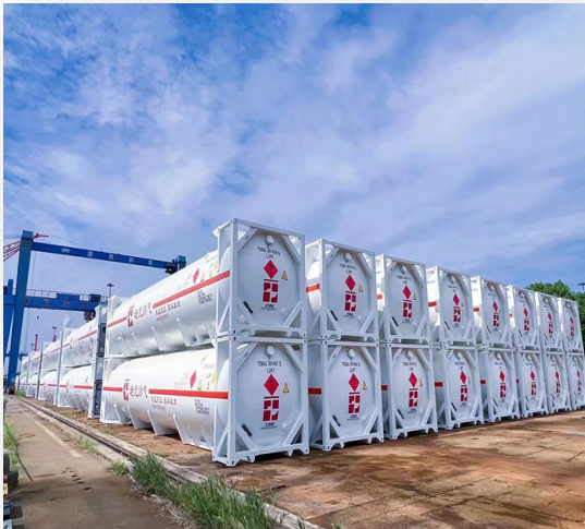
Imagen 8: Contenedor cisterna de GNL de 40 pies /45 pies T75, tomado de CSSC Chengxi (Taizhou)
