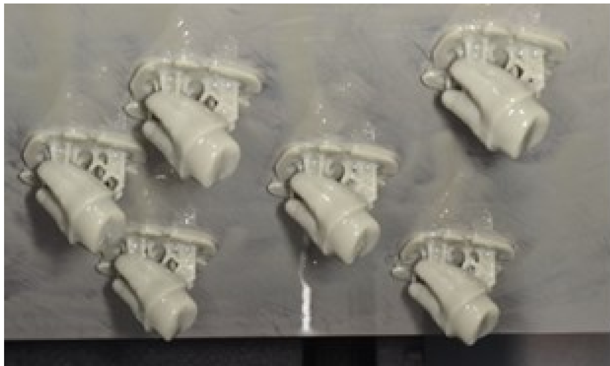
Figura 1. Impresión 3D de prototipo de diente molar preparado para corona completa
