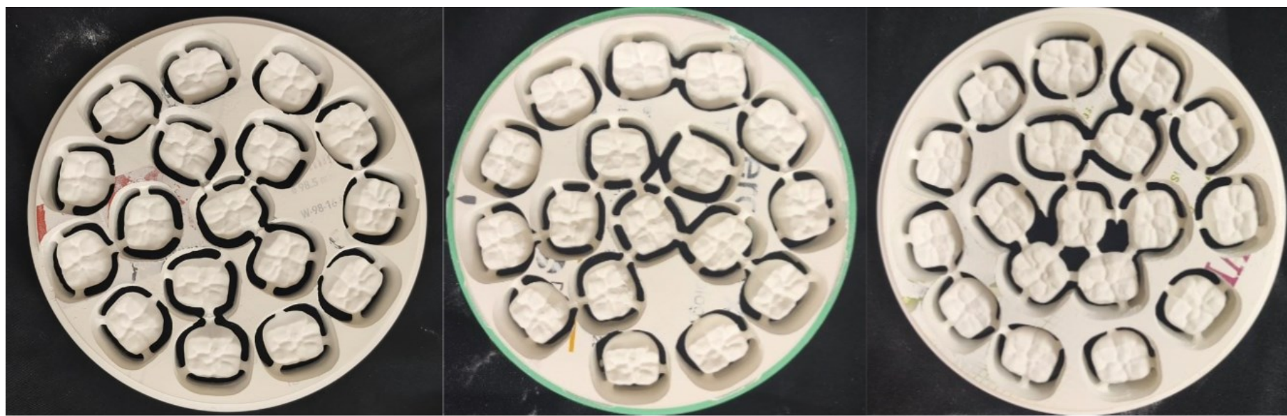
Figura 2. Discos fresados por cada casa comercial SAGEMAX, VITA, DENTSPLY
