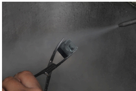
Figura 15. Retiro de cera con vapor caliente
