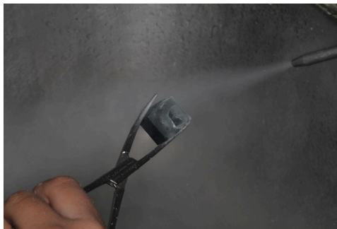
Figura 15. Retiro de cera con vapor caliente
