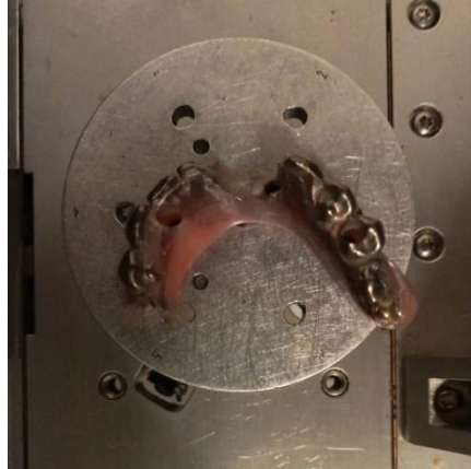
Fotografía 3. Estructura Trilor® con una capa homogénea de oro de 10 nm de espesor.
