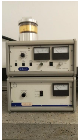
Fotografía 2. Mini Sputter Coater SC7620
