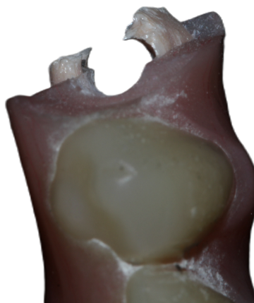
Ilustración 11. Falla cohesiva, se observa fractura complicada con exposición de fibras en zona de multiunit
