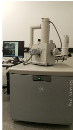
Fotografía 4. microscopio Electrónico de Barrido (FEI – modelo QUANTA 250)
