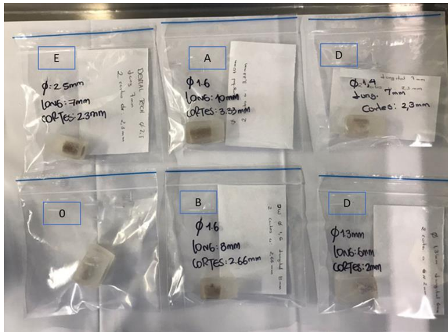
Figura 32. Muestras de hueso de costilla porcino para estudio de microscopía electrónica de barrido por electrones.
